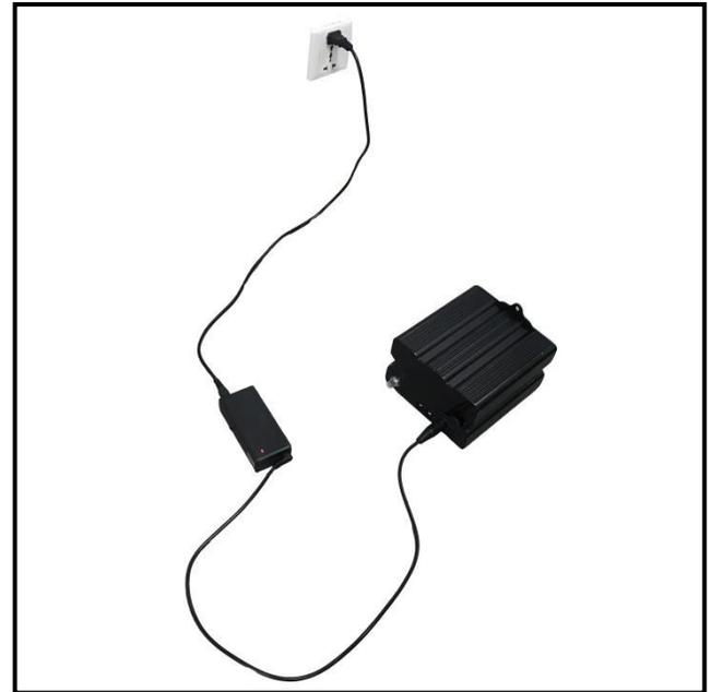
**Abbildung 13. Aufladen der Batterie mit dem Batteriekasten**
