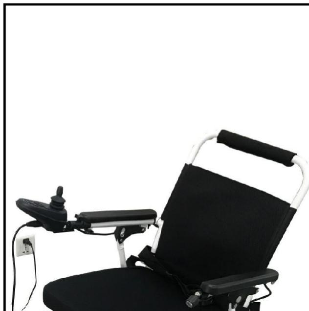
Abbildung 12. Laden der Batterie mit dem externen Ladegerät
